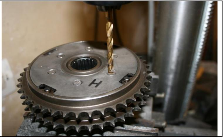
A l'aide d'un chasse goupille Ø 5 mm chasser les rivets.
