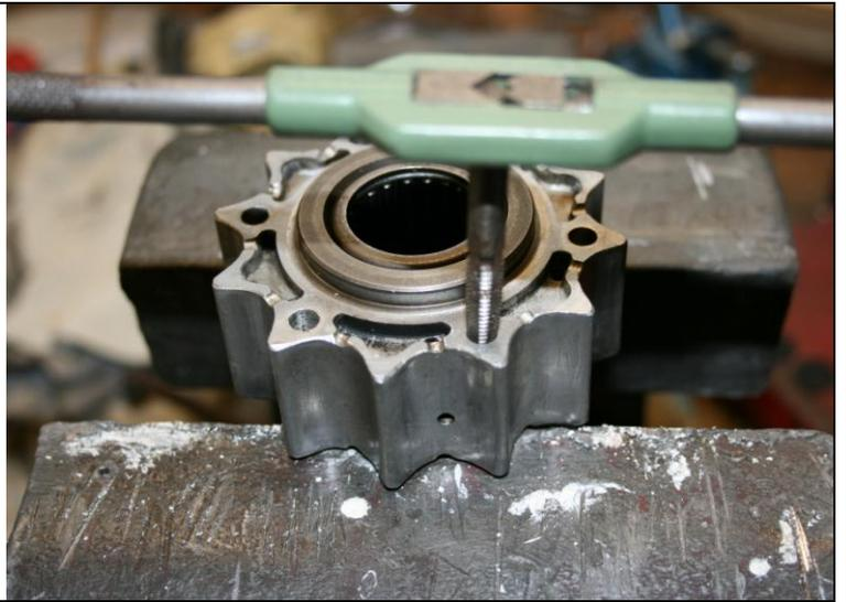
Percer les trous de fixation existant sur les flasques au  $\varnothing 6$
