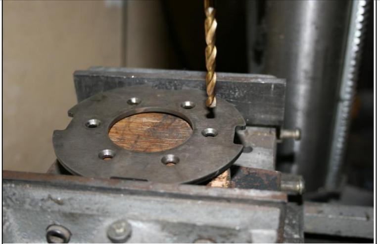
Pratiquer un cône de façon à recevoir les têtes des vis fraisées (Foret  $\varnothing 12$  mm affûté à  $90^\circ$  ou fraise à  $90^\circ$ ). La tête ne doit pas être totalement enfoncée dans le flasque, elle doit dépasser de 5/10 ème de mm.
